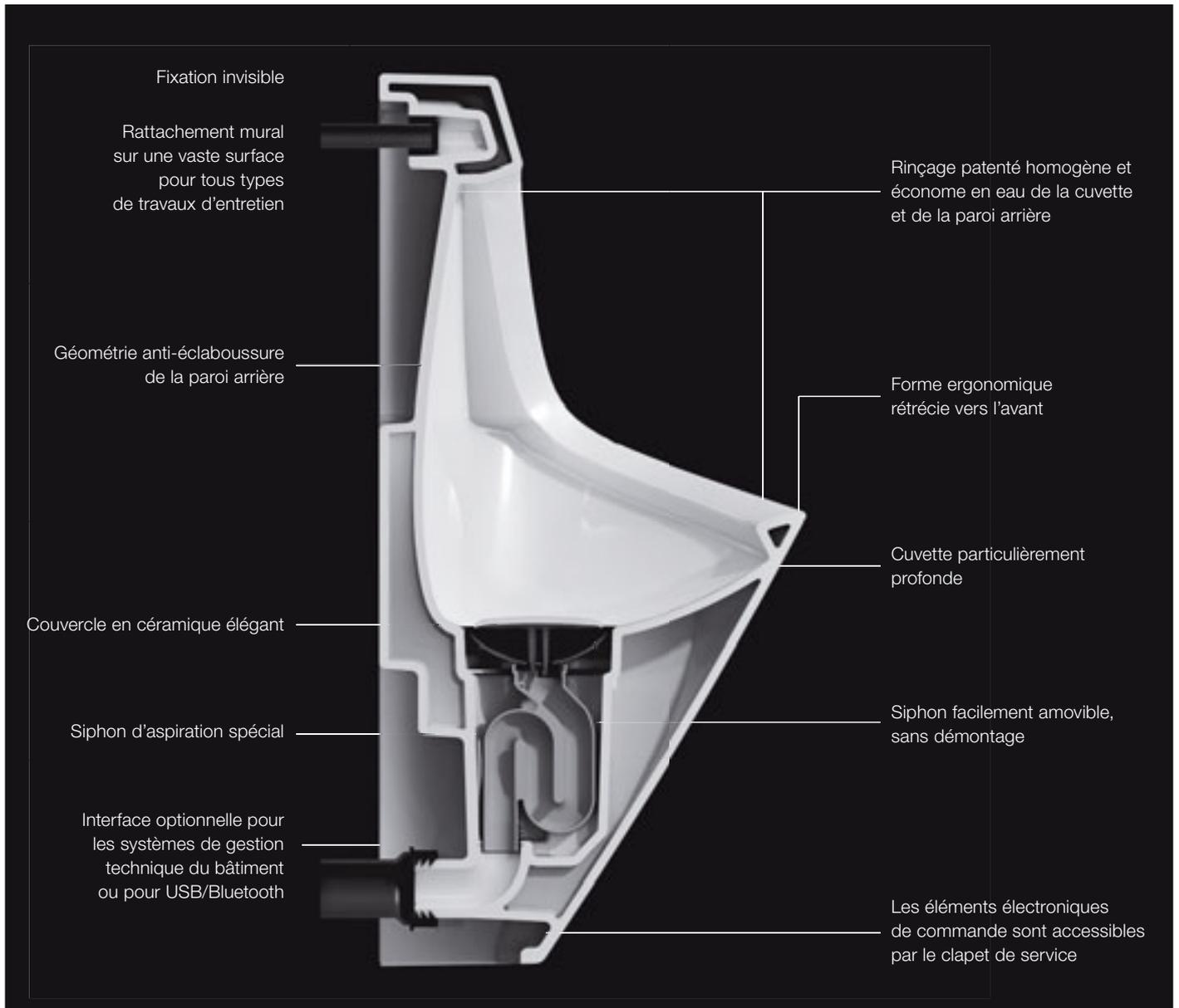
Les urinoirs de LAUFEN vont révolutionner l'entretien et la maintenance des toilettes publiques. Jusqu'à présent les urinoirs devaient souvent être complètement démontés pour remplacer leur siphon. Antero et Lema vous permettent de libérer facilement le siphon à l'aide d'une clé spéciale et de le retirer en le soulevant.
