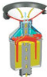
L'urinoir LAUFEN lema **0-litre économise** de l'eau et de l'argent. Il fonctionne sans eau et n'a besoin d'aucun dispositif d'arrêt ou d'électricité pour fermer la canalisation. L'urine elle-même aide à renfermer les gaz et à éviter leur échappement. Le principe de ce piège est connu dans l'industrie chimique sous le nom de «*fiolo d'erlenmeyer*».
