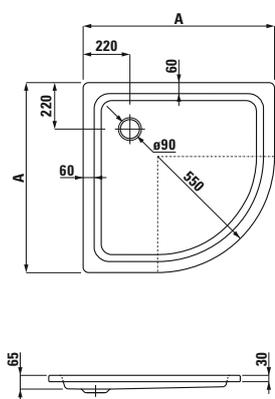
Receveur de douche en acier, plat, profondeur de 65 mm, acier émaillé de 3,5 mm, avec patins antibruit selon SIA181, DIN4109\*
