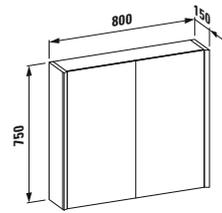
Placard de toilette avec miroir, aluminium, avec éclairage LED vertical, sans interrupteur senseur, réglable
